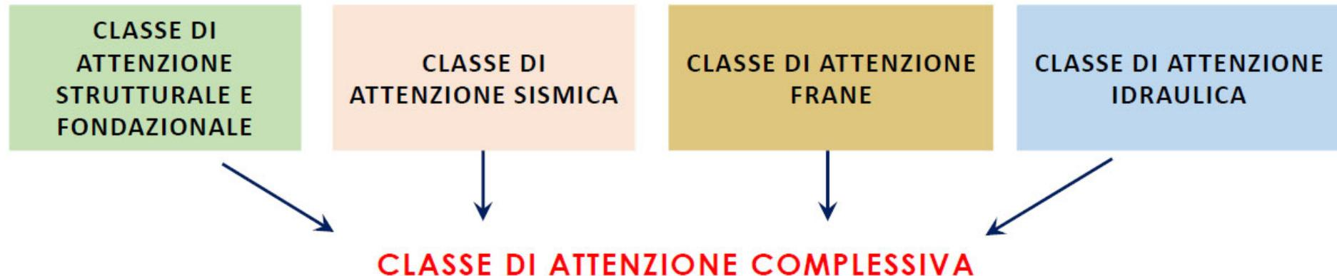
Indice sintetico risultato della **combinazione delle classi di attenzione strutturale e fondazionale, sismica**, legata al rischio **idraulico** e legata al rischio **frane**, valutate prima separatamente e poi combinate ancora una volta secondo un approccio per classi e operatori logici.
