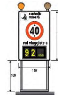
FIG. 20: dissuasore su cavalletto con rivelatore radar di velocità
