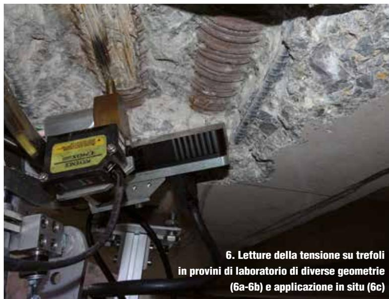
6. Letture della tensione su trefoli in provini di laboratorio di diverse geometrie (6a-6b) e applicazione in situ (6c)
